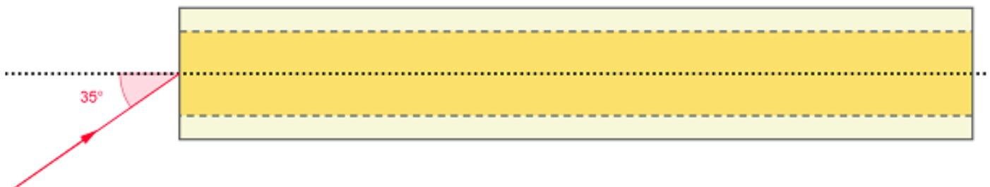
4) En utilisant le principe de la réflexion totale schématisé ci-dessous à l'intérieur de la fibre optique, prolonger le rayon lumineux dans le schéma ci-dessus jusqu'à la sortie de la fibre.
