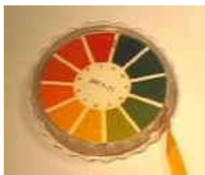
Pour mesurer le pH, il suffit de déposer une goutte de solution sur la languette de papier pH et de comparer la couleur obtenue avec le panel de couleur fourni avec le papier. Attention ! Un papier pH est composé d'un mélange de différentes substances qui changent de couleurs selon les concentrations en  $H_3O^+$  que contient la solution.
