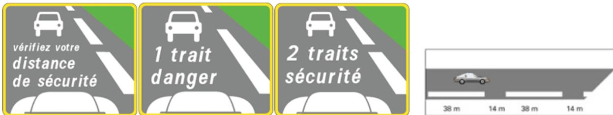
La **distance d'arrêt** d'un véhicule correspond à la **distance parcourue pendant le temps de réaction de son conducteur à laquelle s'ajoute la distance de freinage**.
