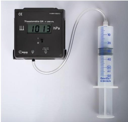
On comprime un gaz en faisant varier le volume dans une seringue et on mesure la pression  $p$  du gaz correspondant. On remplit les deux premières lignes du tableau de mesure suivant, avec une dizaine de mesures, réparties tous les 2 à 3 mL.
