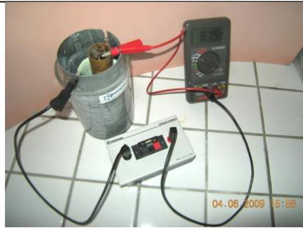
On fait débiter la pile dans un circuit résistif et on mesure une intensité de l'ordre d'une dizaine de mA.
