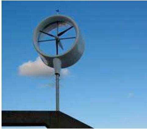
Les éoliennes conçues pour être soumises à cet effet auront une production plus importante que des éoliennes classiques pour un même diamètre et pour une même vitesse de vent moyen. Il est donc aisément possible de réduire leurs encombrements ce qui impliquera en plus une diminution du bruit et des vibrations émis par l'éolienne.
