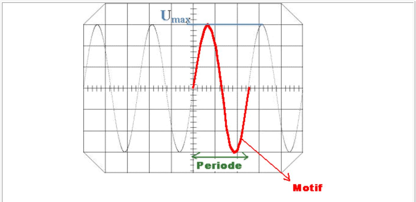
La tension maximale est de  $5\text{V/div} \times 3 \text{ divisions} = 15 \text{ V}$
