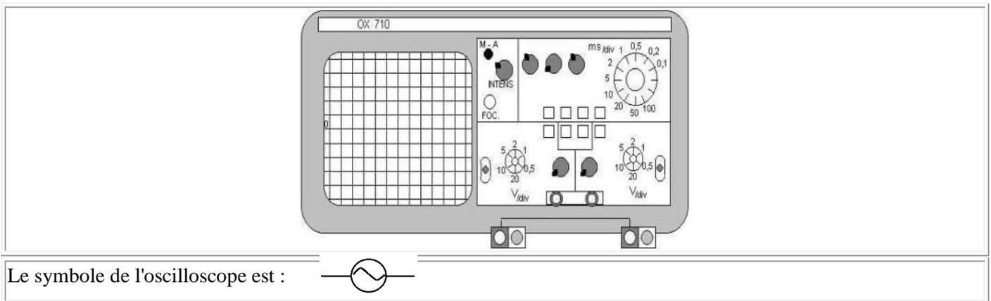
Un **oscilloscope se branche en dérivation** (aux bornes du dipôle dont on veut étudier la tension) exactement comme un voltmètre.
